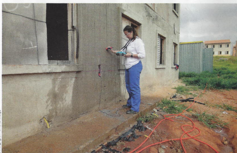
Avaliação de corrosão da armadura (medida de potencial de corrosão) em parede de concreto armado de edifício
